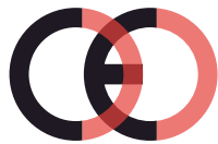
Virheellinen CE-merkki (liian lähellä)
