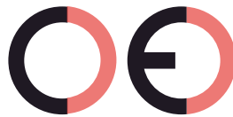
Virheellinen CE-merkki (liian kaukana)
